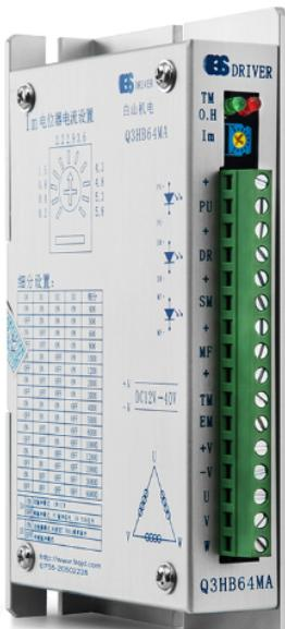
DSP数字式步进驱动器在内部采用类似伺服的控制原理，独特的电路设计，优越的软件算法处理，即使在低细分条件下也可以使电机低速运行平稳，几乎没有振动和噪音；平滑、精确的电流控制技术很大程度减小了电机发热；外置16档等角度恒力矩细分，较高200细分；光电隔离差分信号输入，抗干扰能力强；具有过压，欠压，过流保护等出错保护功能；在点胶机、激光雕刻等中、低速应用领域，其平稳性、振动、噪声性能优势明显，可很大程度提高设备性能。驱动器是否能正常工作直接影响设备的整体性能。甘肃智能分段变光驱动器
